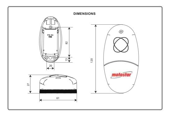
Récepteur à deux canaux, pouvant être associé aux émetteurs de la série CLIK. Les deux canaux fonctionnent normalement en mode "monostable" avec la possibilité de choisir le mode "bistable" (interrupteur) sur le 2° canal.
